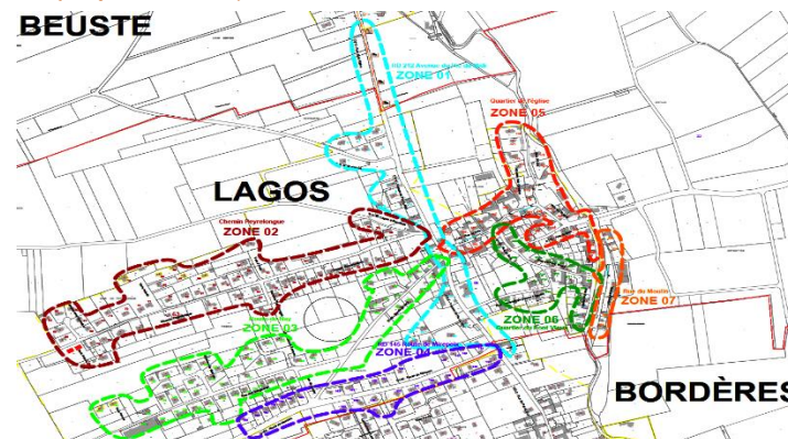
7 zones de travaux à déployer en fonction du sens de circulation des véhicules et des accès aux chantiers (2 entreprises de travaux)
