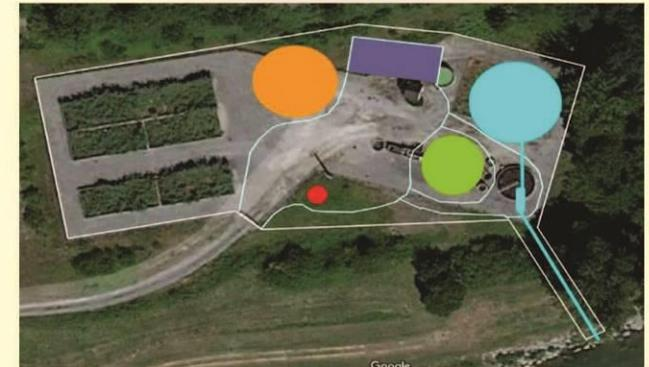
Implantation des nouveaux ouvrages hydrauliques et de commande sur le site de la station d'épuration d'Asson
