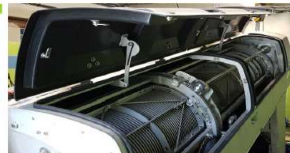
Nouvelle génération de presse à vis pour déshydrater les boues à Baudreix
